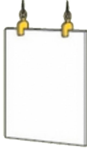
Vertical lifting of steel plates / Izaje vertical de láminas de acero
