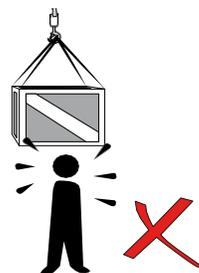
1. No sobrecarga el dinamómetro. Verifique la capacidad de carga antes de utilizar el equipo.
