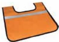
**Amortiguador de Línea:** El propósito de este accesorio es reducir el riesgo de lesiones debido al efecto látigo que se produce en el caso de que en un cable o una correa de recuperación se corte durante la operación. Tiene la forma de una manta con bolsillos para ser llenados con pesos como arena o piedras. Una vez cargado deberá ser doblada alrededor del cable antes de realizar la maniobra de tiro.
