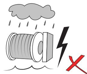
**6.** Evite el uso del Winche en la lluvia. No moje el interruptor ni el motor.
