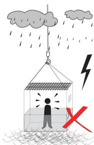
**10.** No opere el equipo para izaje de personal si el viento supera los 20 km/h o durante lluvia, nevada, niebla, tormenta eléctrica o cualquier otra condición que pueda producir un accidente en potencia.
